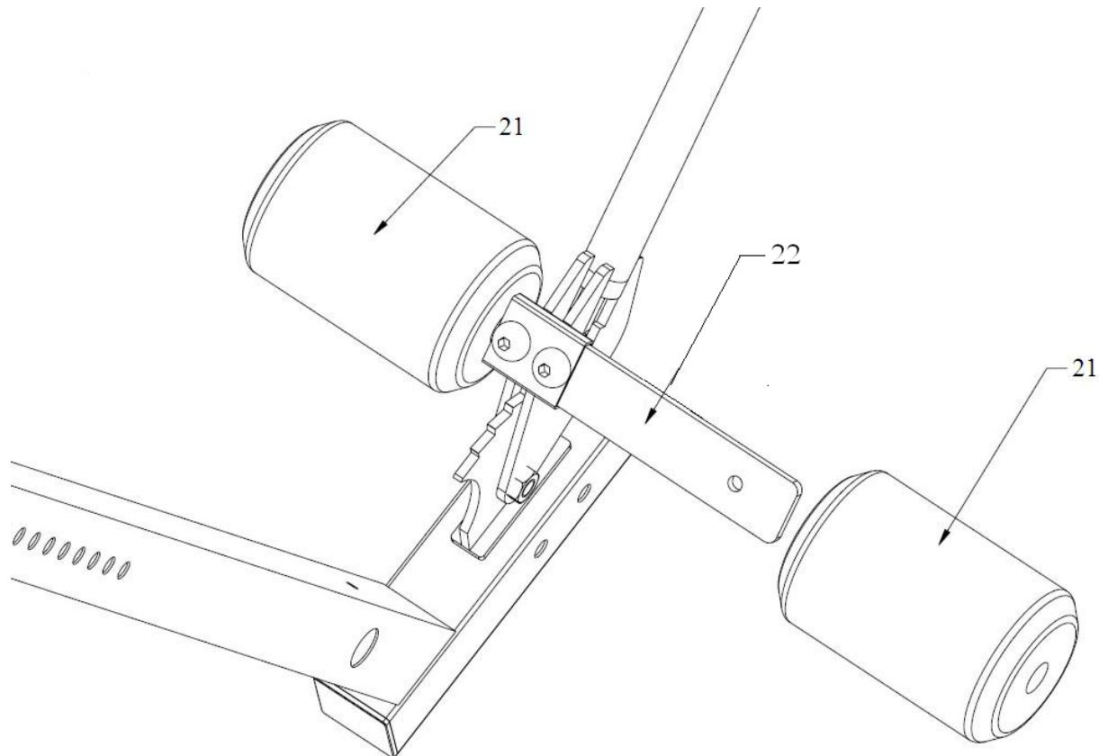
Соедините круглый стержень #22 и скобу держателя ног #15 с помощью винтов #29 и гаек #13.
